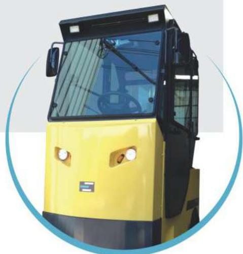
Cabine fechada standard opcional para proteção climática ou ainda com opções de ar condicionado ou climatizador.
